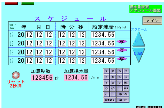
揚水スケジュールの設定画面
